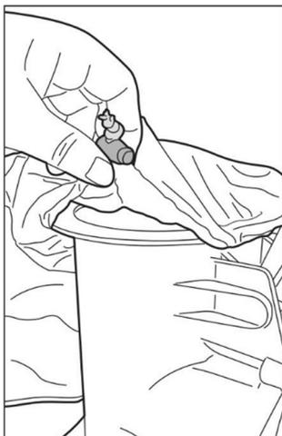
Spreid de filterzak over de bovenste opening van de hoofdbehuizing van de zwembadstofzuiger. Zorg ervoor dat het koord van de zak onder de flens van de bovenste opening is geplaatst.
