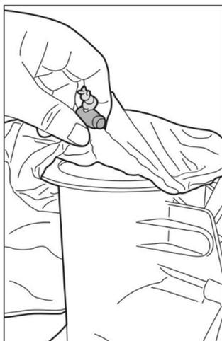
Disposer le sac de filtration sur l'ouverture du haut du corps principal de l'aspirateur. Assurez-vous que le cordon du sac soit placé sous la bride de l'ouverture.
