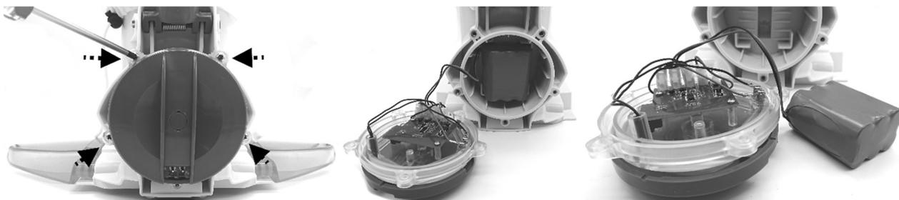
2. Om de batterijverbindingsdraad los te maken, drukt u op de clip van de connector om deze eruit te trekken. **OPMERKING:** Wikkel de connector onmiddellijk met isolatietape in om kortsluiting door het contact van beide draadaansluitingen te voorkomen.
