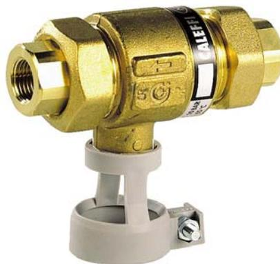
Installer le disconnecteur horizontalement après une vanne d'arrêt et un filtre accessible pour l'inspection; en aval, monter une autre vanne d'arrêt.
