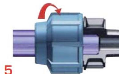
5. Visser l'écrou d'accouplement en le serrant à fond. Serrage manuel ou mécanique (par exemple avec clé à tube) jusqu'au diamètre D 32. Serrage mécanique (avec clé de montage) à partir du diamètre D 40.
