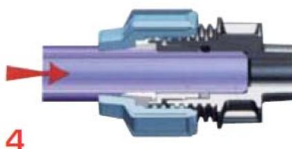
4. Continuer de pousser le tube jusqu'à la seconde butée : le montage est correct (contrôler la marque sur le tube).
